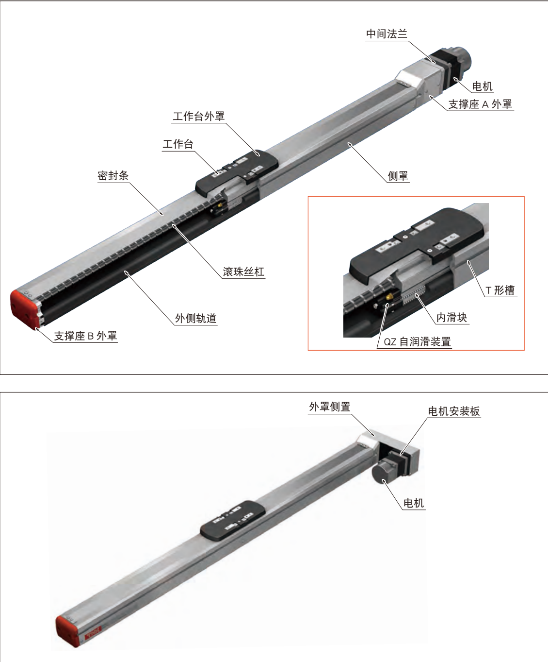
图 6 KSF 全盖的结构和各部分名称
